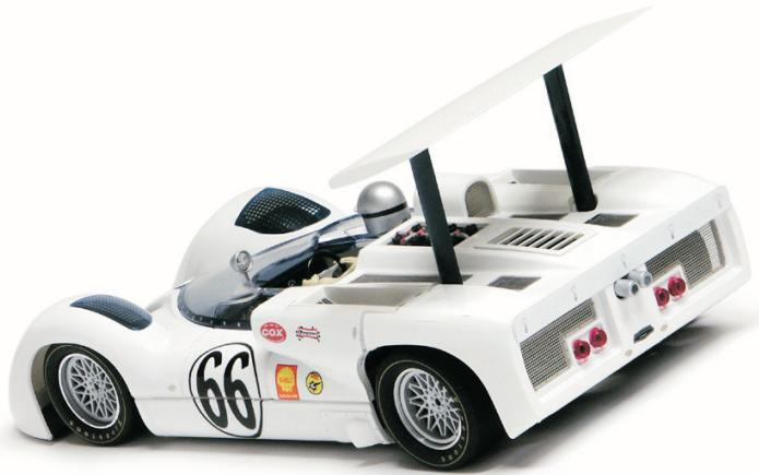
Nel 1966 la Chaparral introdusse la 2E nelle gare della serie Can-Am. Con il suo alettone, un'aerodinamica intelligente ed i radiatori posteriori, la vettura anticipò i concetti che sono alla base delle auto da corsa contemporanee.
